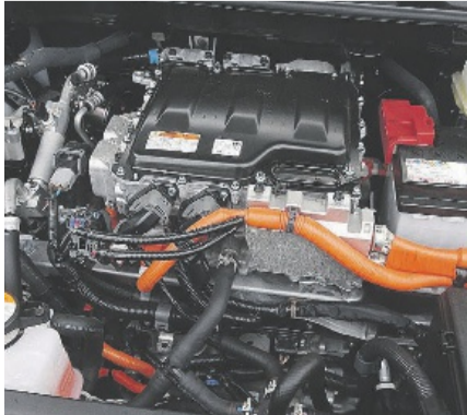
Der zweite Elektromotor für den Allrad ist vorne.
